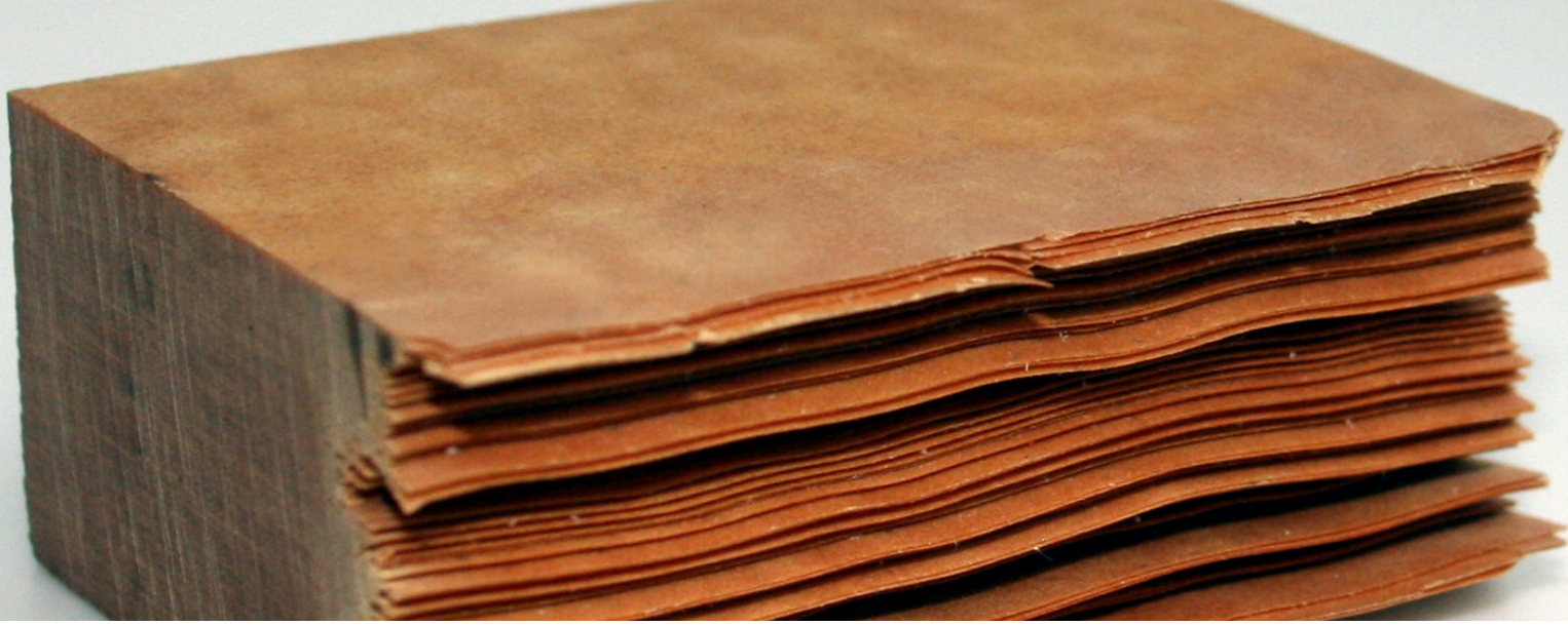
Schichtartiger Aufbau der Richlite®-Platten
